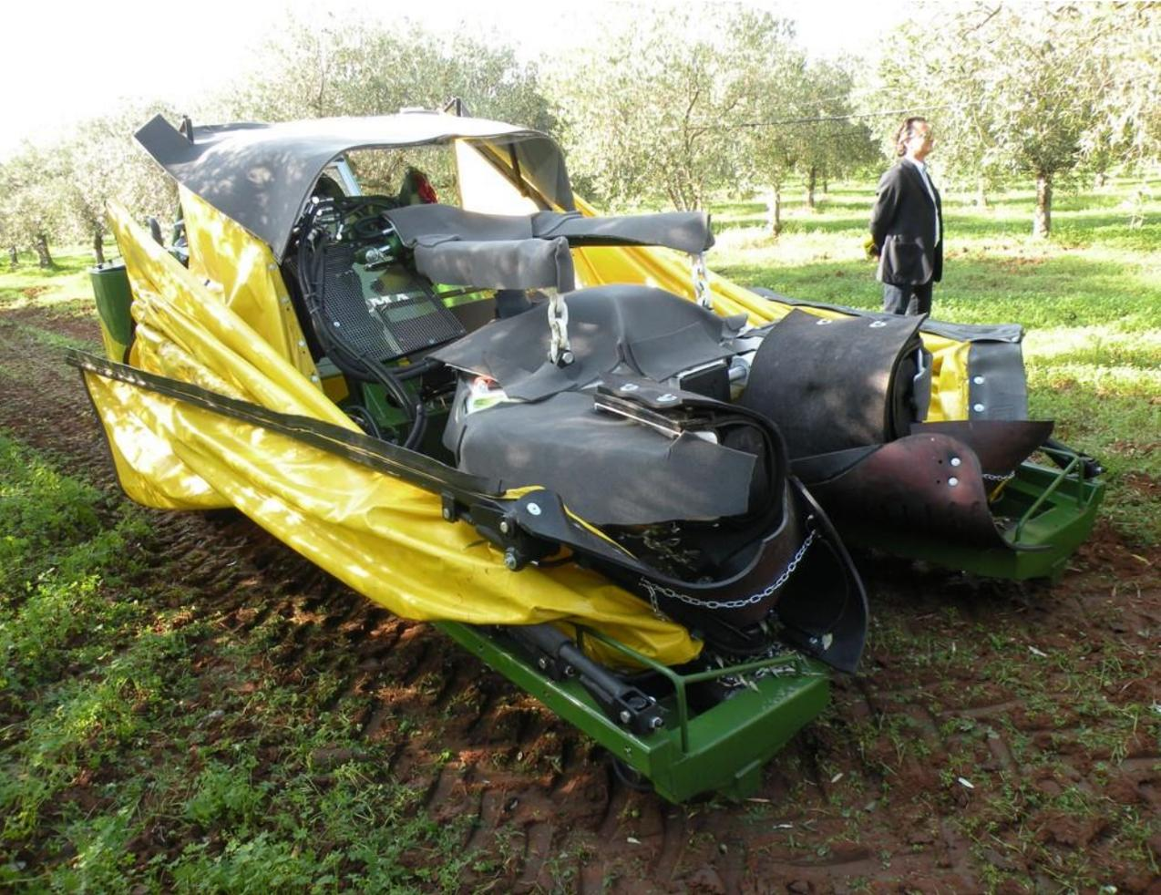
**Protezione delle parti rigide del telaio intercettatore con gomma piuma**
