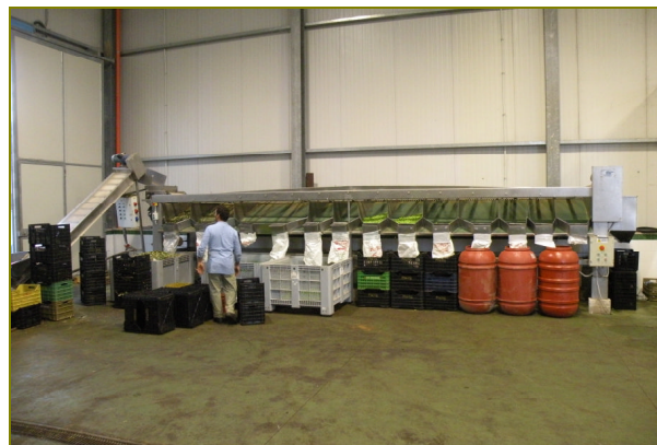
Figura 5. Macchina per la cernita delle olive in uno stabilimento per le olive da tavola della Sicilia occidentale.
