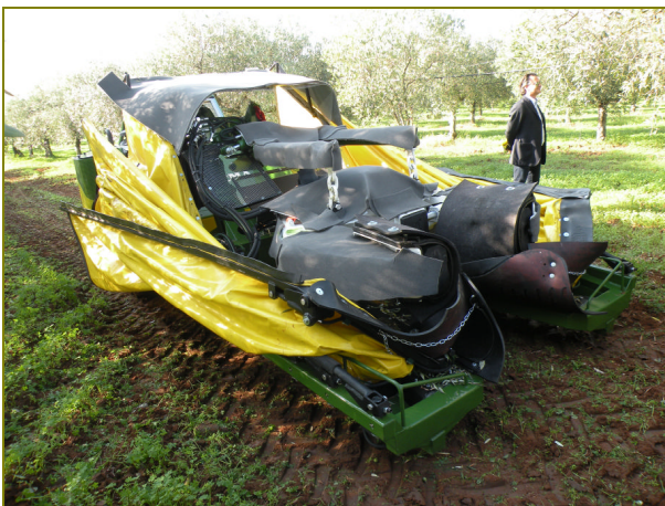
Figura 8. Scuotitore con telaio intercettatore in cui le parti metalliche sono coperte con del materiale spugnoso per attutire l'urto delle olive intercettate.
