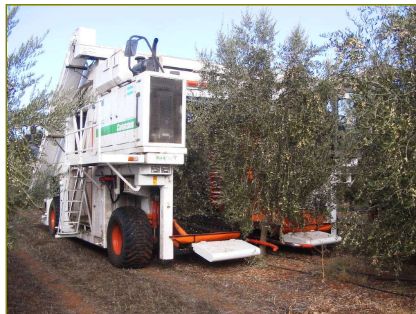
Meccanizzazione della raccolta con la scavallatrice COLOSSUS (Foto Ravetti).
