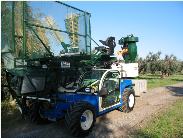
Macchina per la raccolta in continuo CRF OLIVE TWO, che opera in un lato alla volta.
