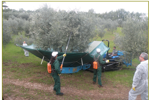
Raccolta in epoca precoce con vibratore del tronco insieme ad agevolatori per aumentare le rese di raccolta.
