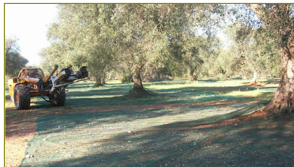
Meccanizzazione della raccolta in alberi di grandi dimensioni con vibratore applicato sulle branche principali.
