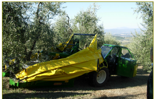
Raccolta meccanica in un oliveto adulto intensivo con vibratore del tronco semovente dotato di un telaio intercettatore ad ombrello rovescio.
